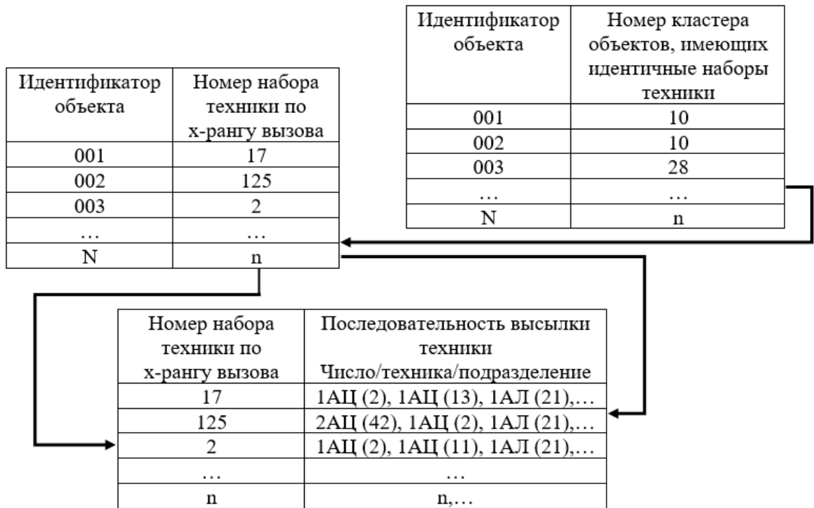
Рисунок 2.4 – Реляционная модель данных очередности (наборов) привлечения оперативных отделений на пожары повышенных рангов
